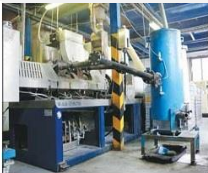
Фото 2. Главным компонентом экструзионной линии для вторичной переработки ПЭТ на заводе компании RTP в Чехии является экструдер типа MAS 75 с производительностью до 1300 кг/ч
