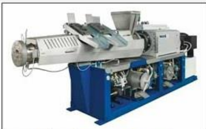
Фото 1. Разработанный на основе принципа «новой конической технологии» (NCT: New Conical Technology) экструдер MAS имеет модульную конструкцию и выпускается в шести типоразмерах с производительностью от 200 до 1800 кг/ч; на фото показан вариант с устройством для загрузки ПЭТ-хлопьев (все иллюстрации: MAS)
